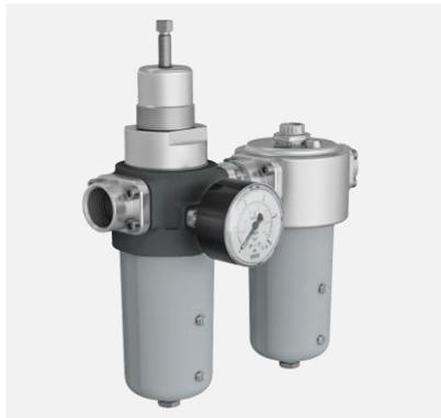
Gruppo filtro-regolatore + lubrificatore (210FR + 210L2) Riduttore di pressione auto-azionato con otturatore bilanciato. Il controllo della pressione in uscita è gestito da un pistone. Funzione relieving e scarico della condensa. Lubrificatore con manopola o vite per la regolazione della quantità di olio immessa nel flusso.
