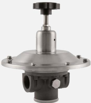
Valvola di sfioro autoazionata per applicazioni in cui è richiesto un preciso controllo della pressione di sfioro, fino a 700 mbar. Il controllo della pressione di sfioro è gestito da una membrana.
